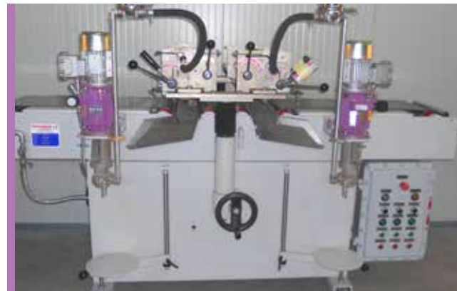
Lackgießmaschine: Regelgetriebe K2 an Dosierpumpe
