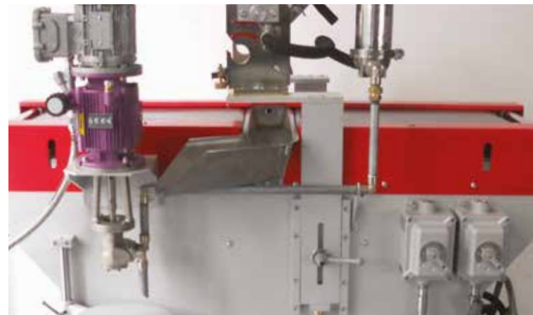
Lackgießmaschine: Regelgetriebe K2 an Dosierpumpe (Atex-Zone)
